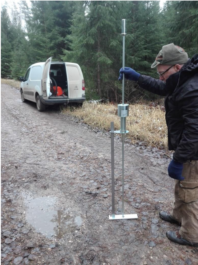
Foto 1. DCP penetromeetri kasutamine Selja Mägede teel. (01.12.2020)
